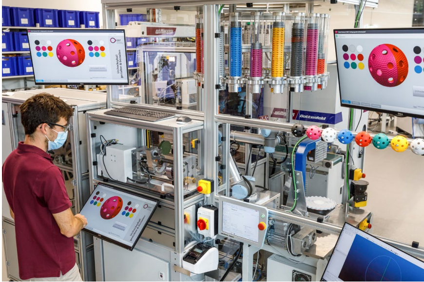
Die Fertigungszelle für Unihockeybälle ist ein Paradebeispiel dafür, wie ein voll automatisierter Produktionsprozess funktioniert. (Foto: «Ost»)
