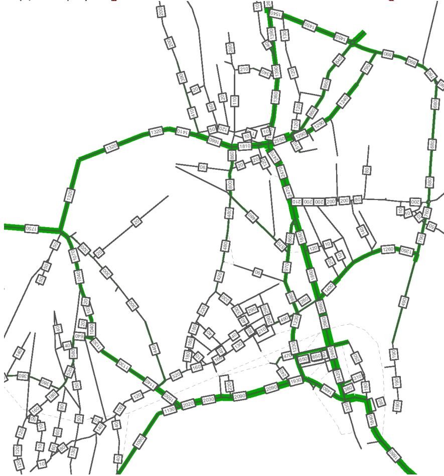
Abbildung 20: Belastung Verkehr nur aus Potenzialflächen im unbelasteten Netz [Fz/Tag]
