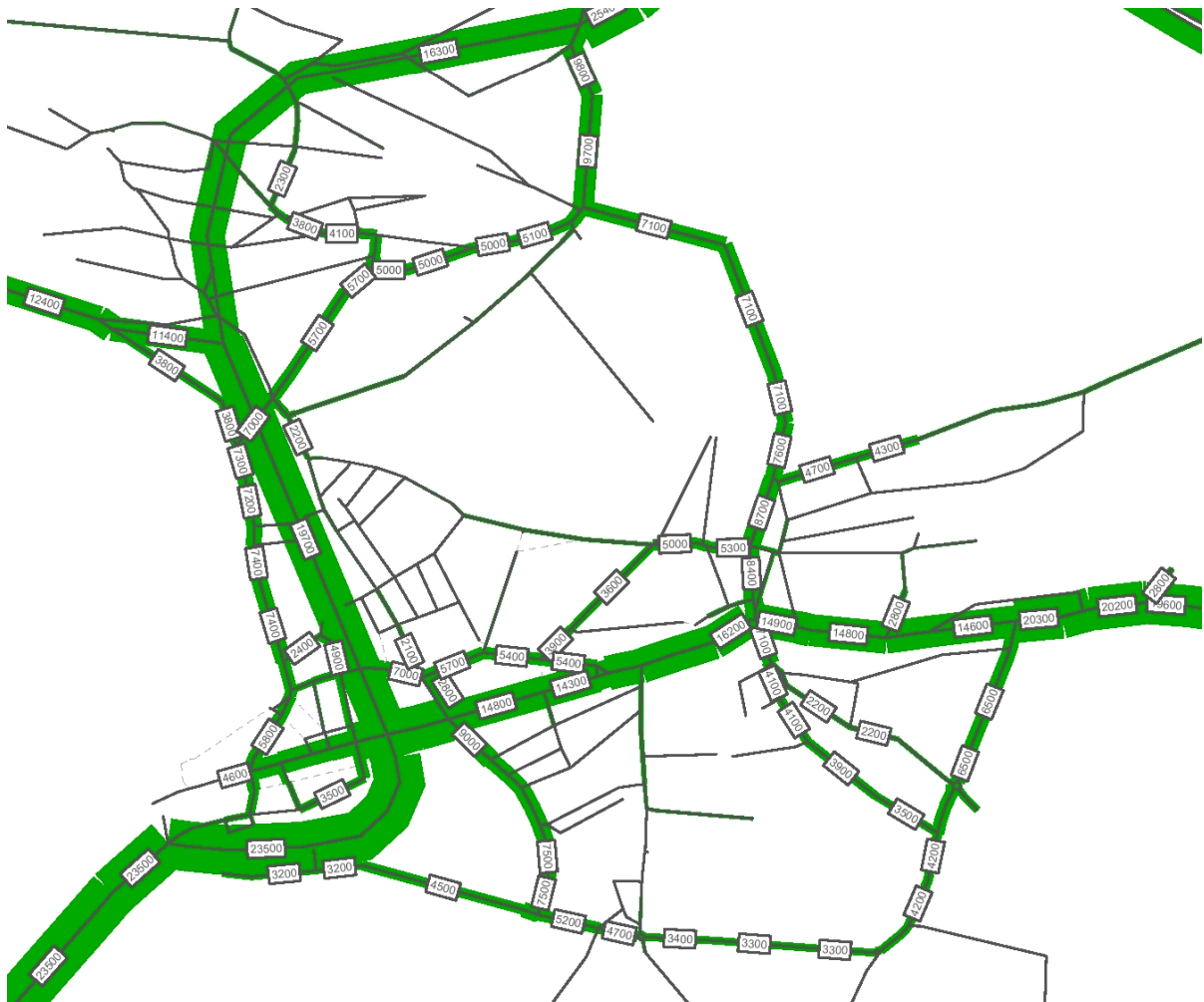
Abbildung 22: DTV 2015 mit Tunnel Seedamm-Hüllistein und flankierenden Massnahmen im Zentrum von Rapperswil [Fz/Tag], Mehrverkehr aus Potenzialflächen berücksichtigt
