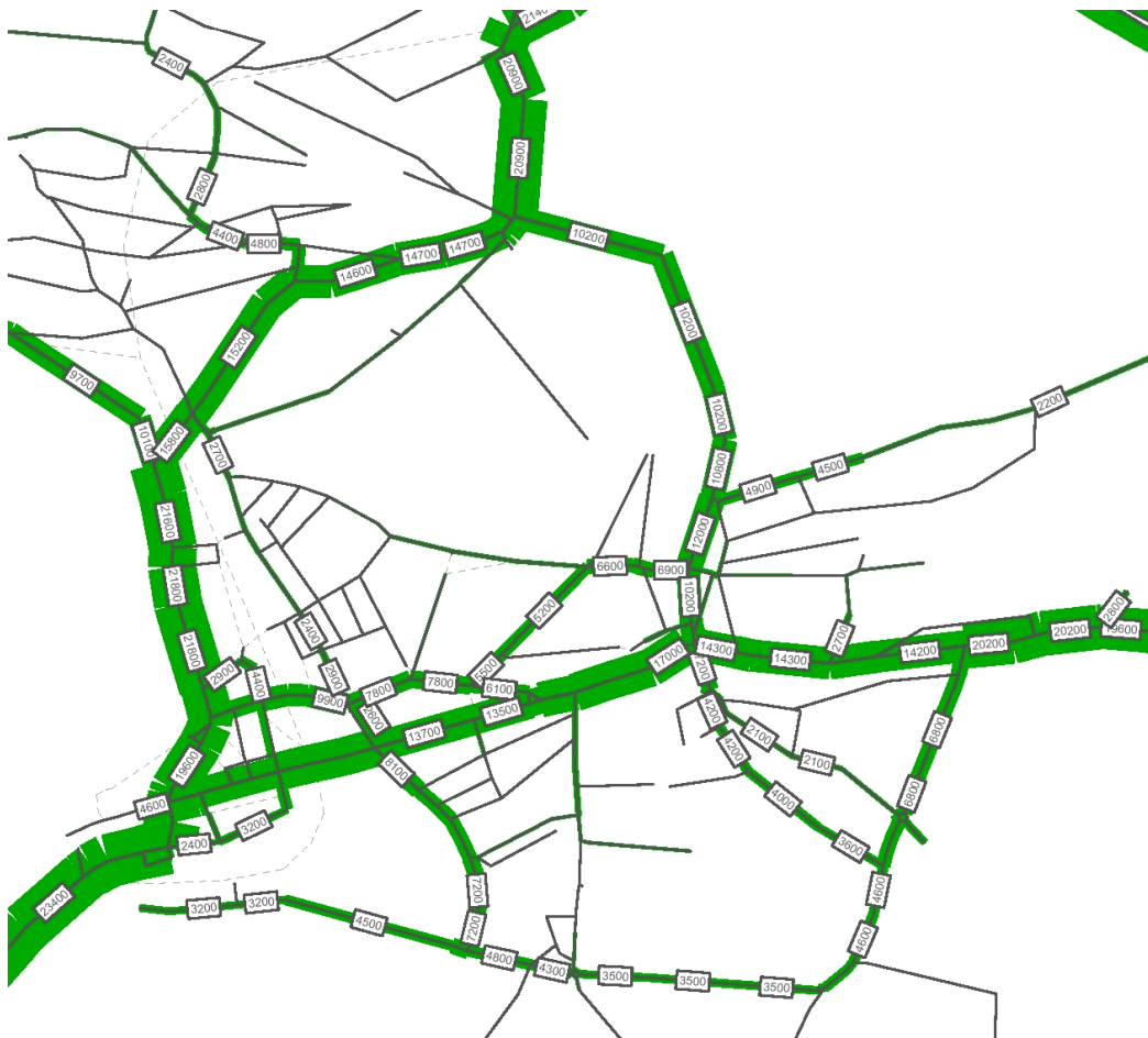
Abbildung 24: DTV 2015 ohne Tunnel [Fz/Tag], Verkehr aus Potenzialflächen berücksichtigt
