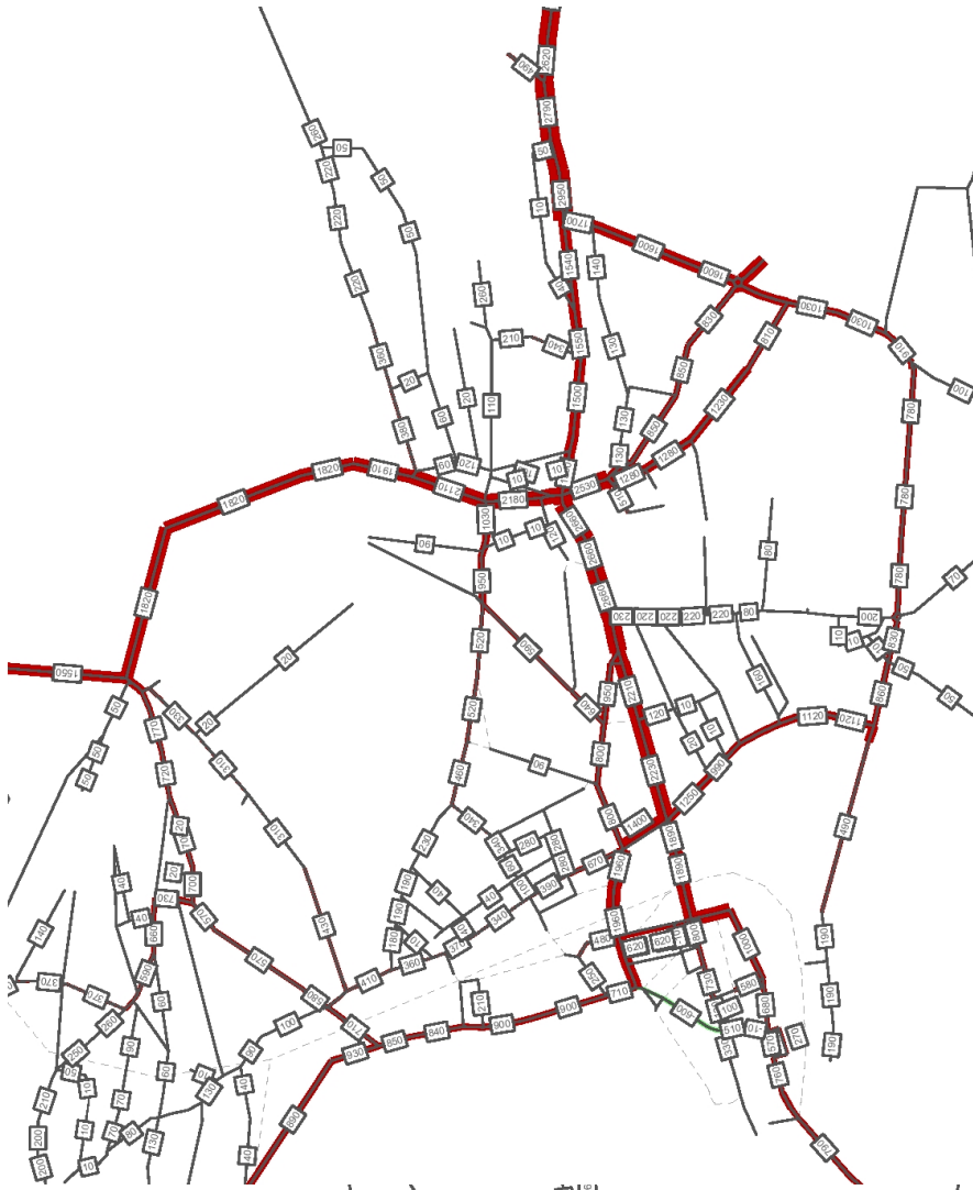
Abbildung 21: Belastung DTV 2001 mit Verkehr aus Potenzialflächen [Fz/Tag]; Differenz zu Ist-Zustand
